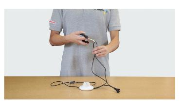
**7.** Coloca el foco en el socket y el fusible en el portafusible.
