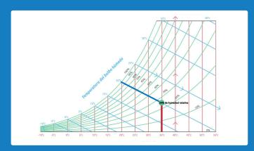
**4.** Observarás una diferencia de temperaturas, con ayuda de una carta psicrométrica sigue la línea de "temperatura de bulbo seco" que es la temperatura del ambiente, y sigue la línea de "temperatura de bulbo húmedo" que es la temperatura que marca el termómetro con la gasa, el punto donde se encuentran las líneas es el dato de humedad relativa.
