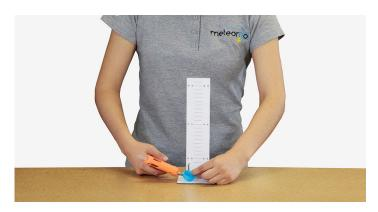
**4.** Toma los dos termómetros y sujétalos a la base con los alambres restantes en ambos extremos (asegurándote que el termómetro con gasa esté del lado de la tapita de refresco).
